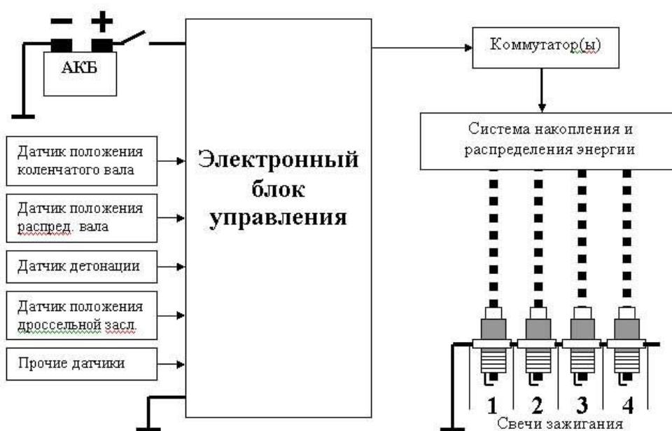
Рис. 18 Электронная ( микропроцессорная ) система зажигания
