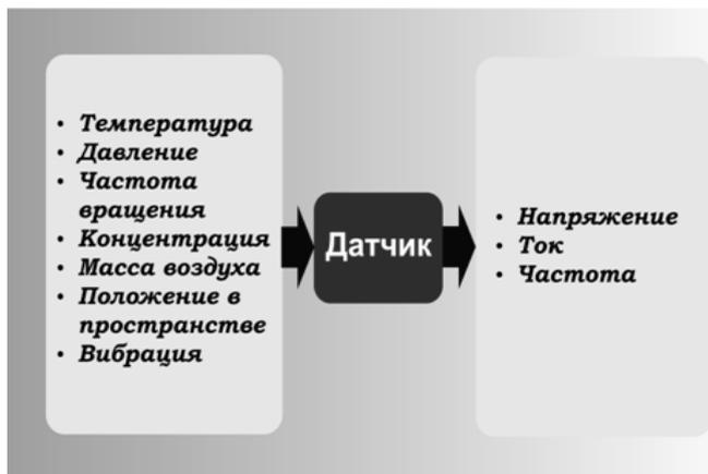
Рисунок 3.1 Простейшая схема работы датчика
